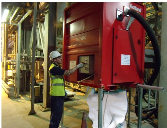
Der DISAB BagVAC™ ist eine elektrisch betriebene Sauganlage, die auf einem stabilen Gestell mit einziehbaren Beinen montiert ist. Diese Einheit ist sowohl für den mobilen Einsatz als auch für feste Installationen ausgelegt und speziell für das Sammeln von Material in Big-Bags konzipiert.
