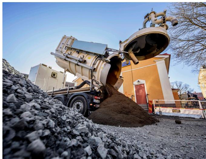
Der DISAB Centurion™ P20 besteht hauptsächlich aus einem fest montierten Maschinenraum mit einer Vakuumpumpe, die von dem LKW Motor angetrieben wird.
